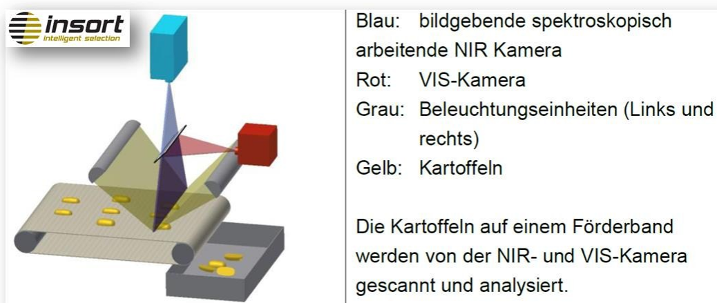
Abb. 6.2.1: Prinzip der bildgebenden Spektroskopie ( hyperspectral imaging ) (INSORT, 2015)
